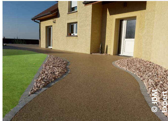
Le béton de résine drainant
