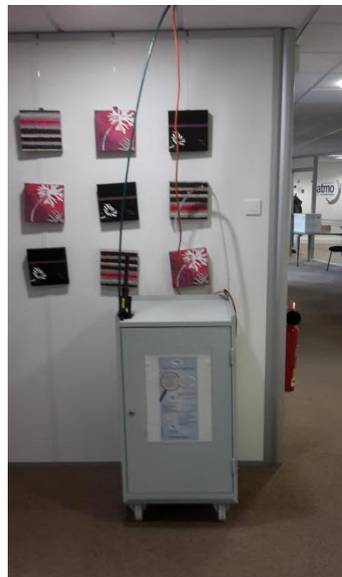
Figure 3 : Dispositif de prélèvements en air intérieur
