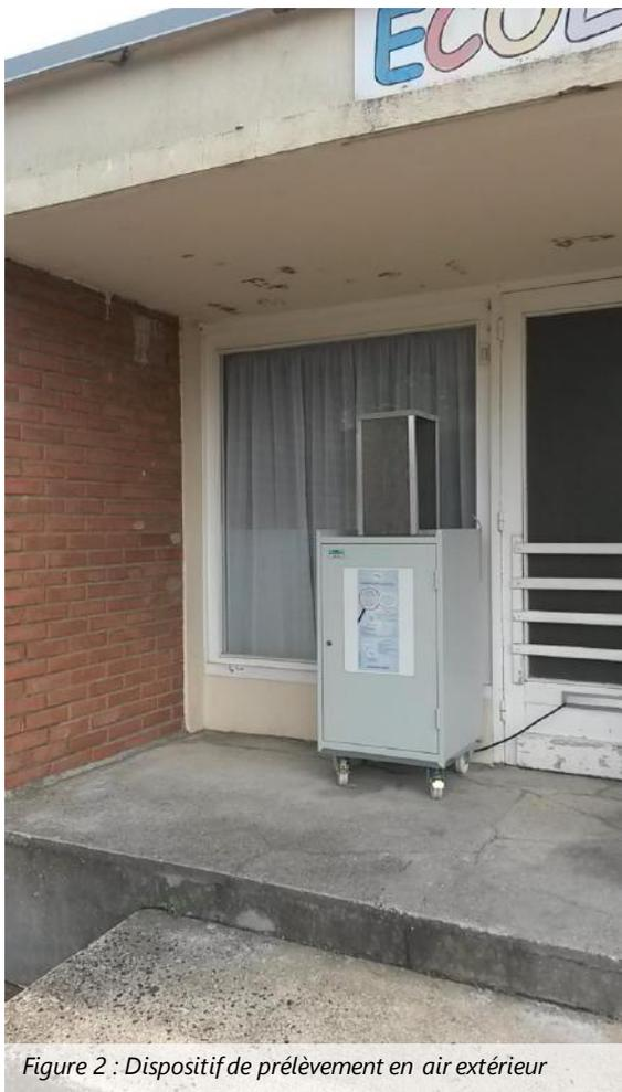
Figure 2 : Dispositif de prélèvement en air extérieur
